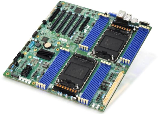
同泰怡 T3DE 双路 E-ATX 标准主板，基于第四代或第五代英特尔®至强®可扩展处理器构建，具备卓越的计算性能、丰富的 I/O 接口和超高的性价比，适用于云计算、虚拟化、分布式存储、超融合等应用。
