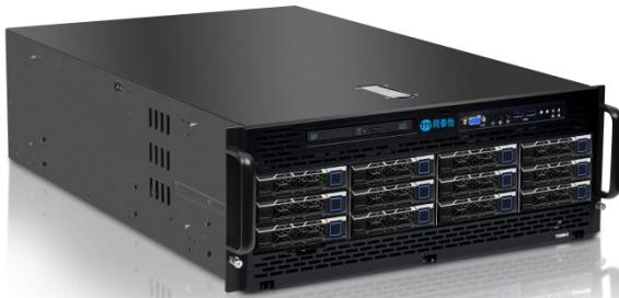
同泰怡 TG556V1 是自主设计研发的一体机服务器产品，支持 2 个鲲鹏模组 Max 版/鲲鹏模组 Smart 版，单模组最大可达 64 核，性能强劲。支持搭载昇腾 GPU，提供强大的并行计算和图形化计算能力。端口多样，支持机架式和塔式两种形态，能够更好的满足客户多种应用场景的需求，为人工智能、建模仿真、图形渲染等应用提供最佳的硬件平台。
